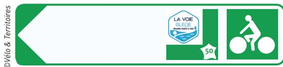
D'après la réglementation, les panneaux de type Dv21c, Dv43c et Dv43d (panneaux directionnels simplifiés) ont en principe les dimensions 300 x 200 mm. La taille du symbole SC2 comme celle du logotype est alors de 125 mm. Toutefois, cette règle de dimensionnement, ancienne, n'intégrait pas la possibilité d'inclure dans ces panneaux simplifiés les identifiants de l'itinéraire.
