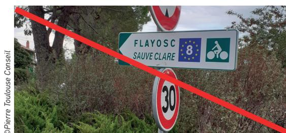
Sur candélabre, la pose est possible avec l'accord de la commune. Sur la signalisation directionnelle, elle est possible avec l'accord du gestionnaire et après vérification du dimensionnement des supports et de leur massif de fondation. La pose sur support de panneau de police est interdite.
