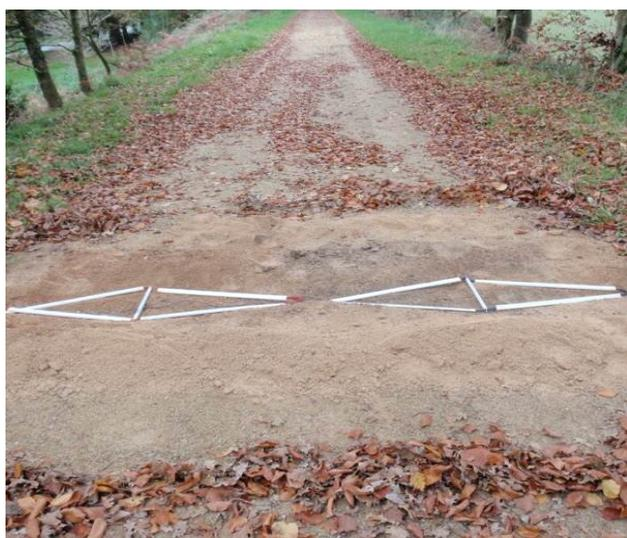
Figure 2 Boucles inductives sur sol naturel, source : Eco-counter
